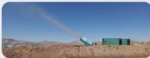
Diseñados para aplicaciones que requieren amplio alcance y cobertura, como tajos mineros, voladuras, acarrees y barreras que evitan el desplazamiento de nubes de polvo y humos hacia las comunidades. Los Evaporadores **Americorp Plus** destacan en la evaporación de relaves, lagos y presas, optimizando recursos y reduciendo inversiones en infraestructura.
